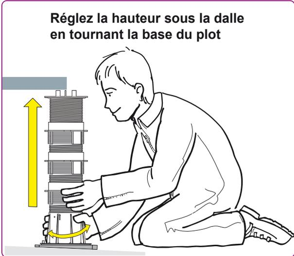
**Plots réglables de 297 à 977mm avec manchon C1-PB-4 et correcteur de pente BC-PH5**
