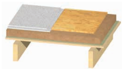
GUTEX Thermosafe-wd ® sur poutres apparentes
