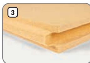
3 GUTEX Multitherm® Panneau isolant insensible à l'humidité, doté d'un profil de densité brute monocouche et homogène, qui sert de revêtement du mur extérieur derrière le panneau de parement ainsi que d'isolation sur et sous chevrons
